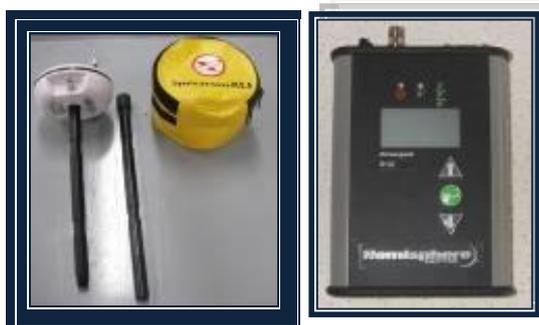
Controladora "Hemisphere GPS". Utiliza servicio "Omnistar" para lograr precisión sub-métrica.
