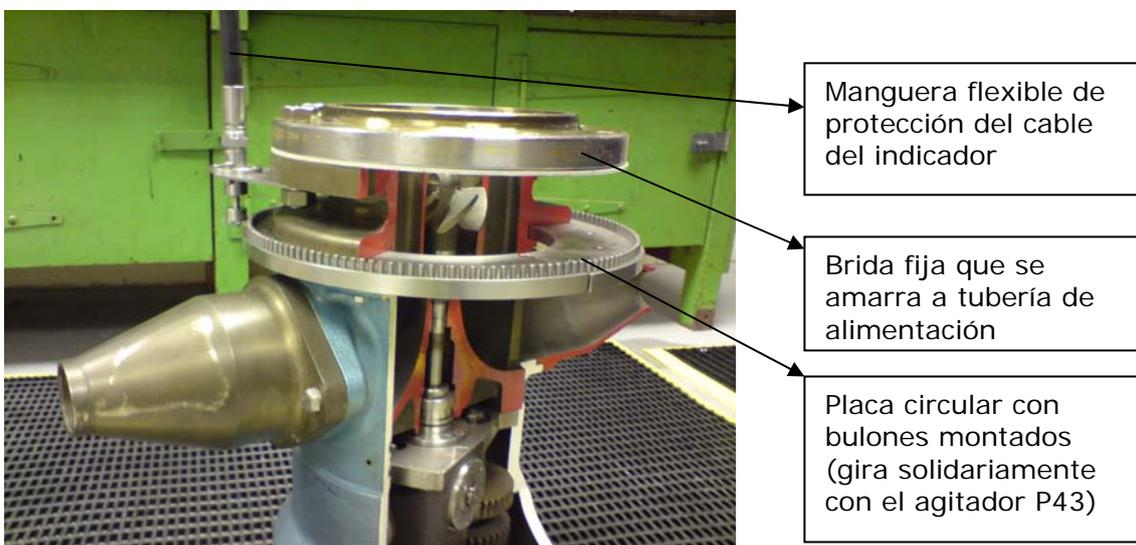
El indicador se suele situar en la boca de hombre (montaje lateral) u otro punto que pueda ser observado desde el exterior del tanque.
