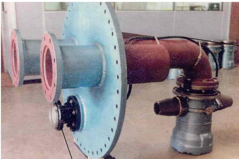
Manguera flexible de protección del cable de mando del indicador visual
