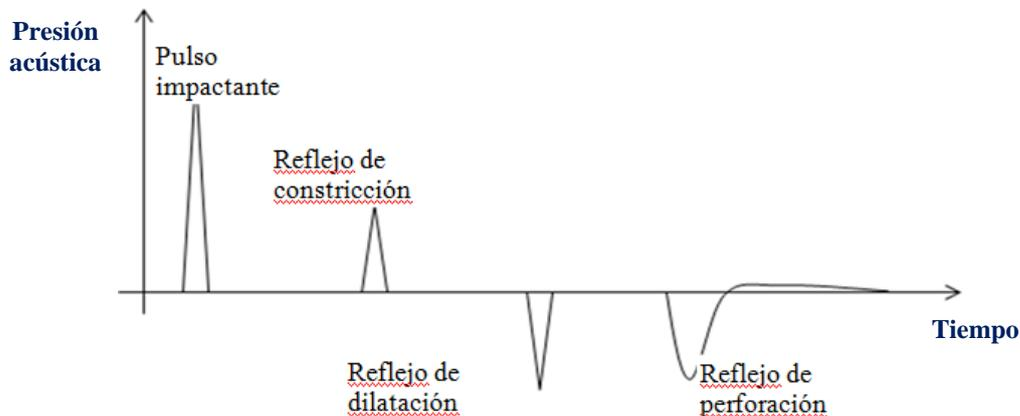
**Figura 2,** Ejemplos esquemáticos de reflejos causados por discontinuidades de diferentes tipos.
