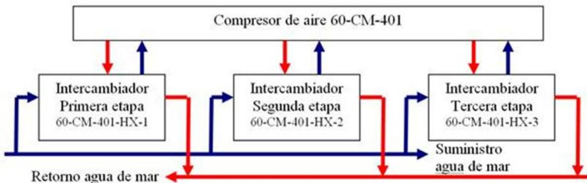
Figura 1, Diagrama a bloques del enfriamiento de aire
