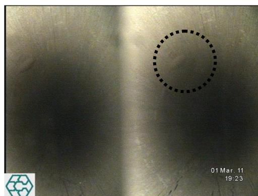
**Figura 7,** Imágenes de inspección visual remota en zonas con indicaciones RPA de tubos del equipo 60-CM-401-HX-2
